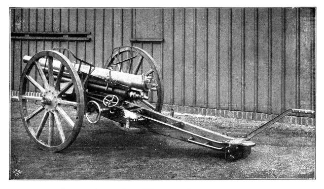
Fig. 1. — Canon Mod. 1899 avec affût à deux cylindres.
