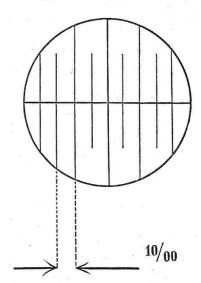
Ma jumelle ayant un grossissement de huit fois un champ de 87 m., elle me permet donc d'apprécier un écart latéral de 40 m. par kilomètre de chaque côté du centre du micromètre, soit un écart total de 80 m. par kilomètre.
