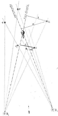
paraîtra à droite du Ballon pour l'observateur B¹, à gauche pour l'observateur B². Ces observations transmises par un signal optique au commandant de batterie lui indiqueront que le coup est devant. Le nuage de fumée en 2 paraîtra à gauche à B¹, à droite à B², d'où le capitaine conclura que le coup est derrière.
