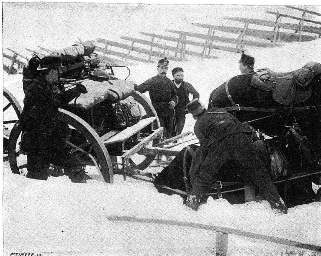
FIG. 5. — Inconvénients de l'attelage de chevaux au timon.
