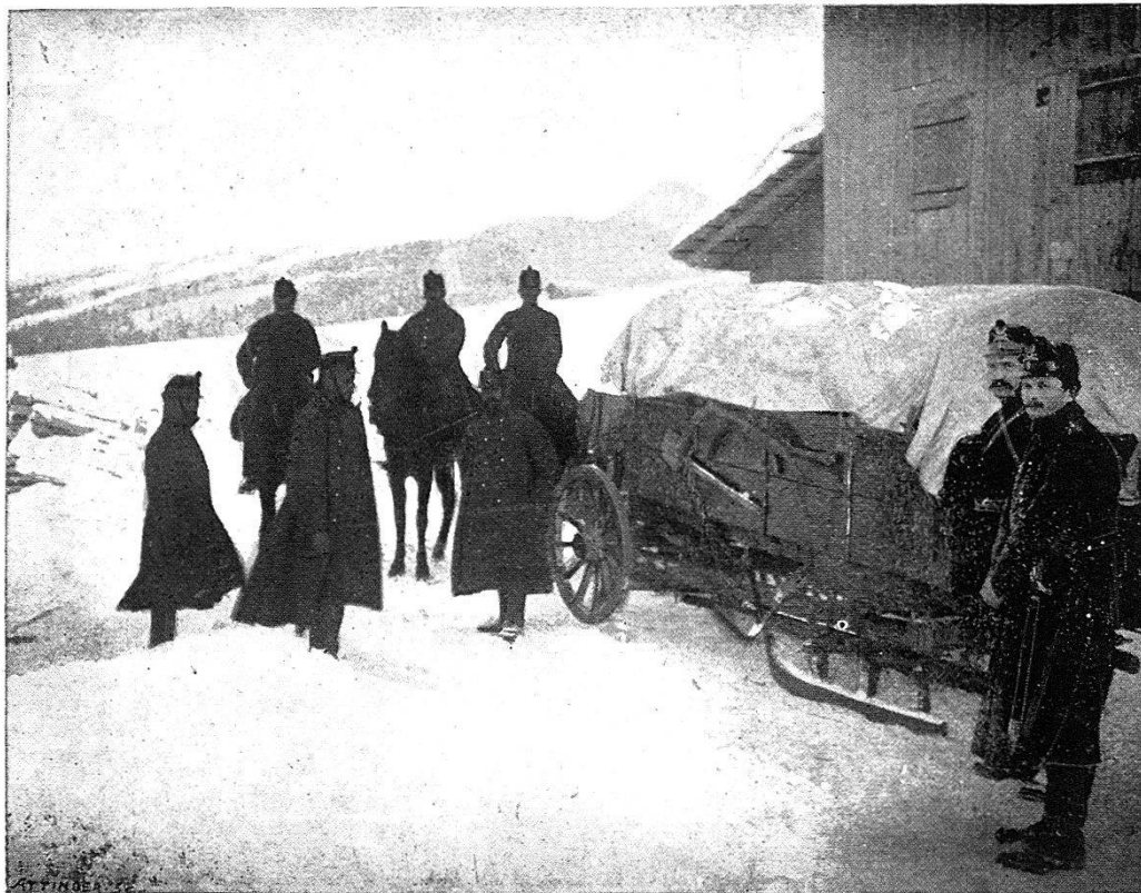
FIG. 10. — Fourgon de batterie, avec arrière-train sur luge.
