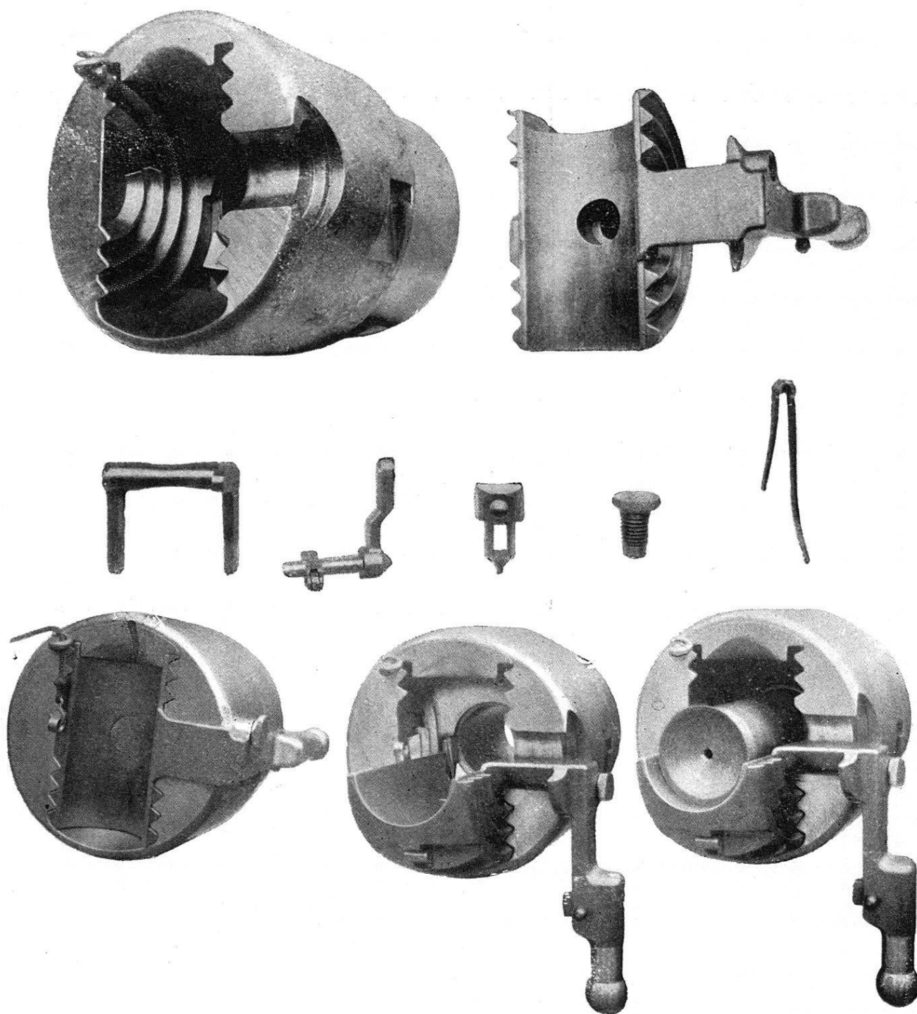
Culasse à tir rapide système CANET. Filets concentriques.
