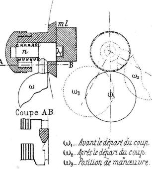
qu'au départ du coup. A ce moment et par la production du recul de la pièce, ce balancier, en vertu de son inertie, se trouve ramené vers l'arrière. En raison de la construction de la tige et de la disposition du logement correspondant, ce mouvement produit un recul de l'ergot vers la gauche, de telle sorte que rien ne s'oppose plus au refoulement de ml dans son logement par l'effet de la pression exercée sur le bouton du levier.
