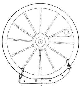
Fig. 7. — Schéma du « lugeon » essayé.
