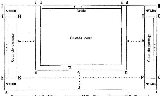
Longueur totale AB, 140 m. - Longueur MB, 68 m. - Longueur CD, 84 m. cd. Longueur Cc et d, 50 m. - Longueur EF, 120 m. - Longueur EH et FI, 48 m. Longueurs AK, IK, BK, MK, 10 m. - Largeur ab, 18 m. - Largeur EK, FK, HK, IK. 10 m. - Largeur cd, 4 m.
