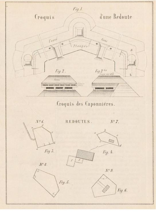
d'embrasures. La face postérieure contient l'entrée, et derrière cette face on a doublé la rangée de palissades, de manière à former un couloir étroit dans lequel on ne pénètre que par une seconde porte, percée de meurtrières qui battent le chemin de ronde, en sorte que la caponnière se trouve ainsi organisée en un réduit indépendant.
