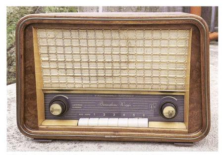
1960 - Ricevitore radiotelefono Biennophone 6 canali sintonizzati OL (MdR).
