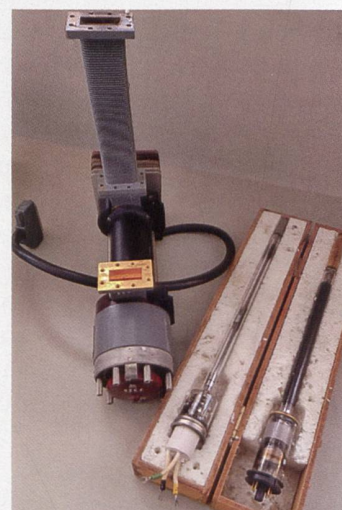
TWT e loro contenitore con guida d'onda (©MdR); L = 30 cm ca.
