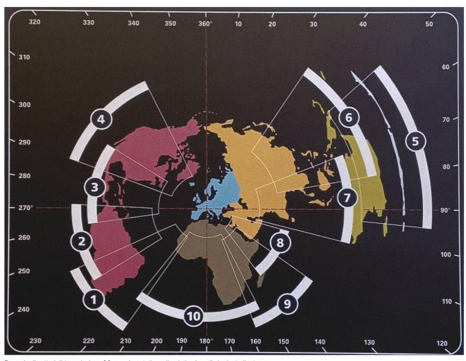
Esempio di settori di trasmissione OC esperimentati e collaudati sui quali si orienta l'antenna. In questo caso dalla stazione radio delle OC Svizzera (1932-2004). (MdR).
