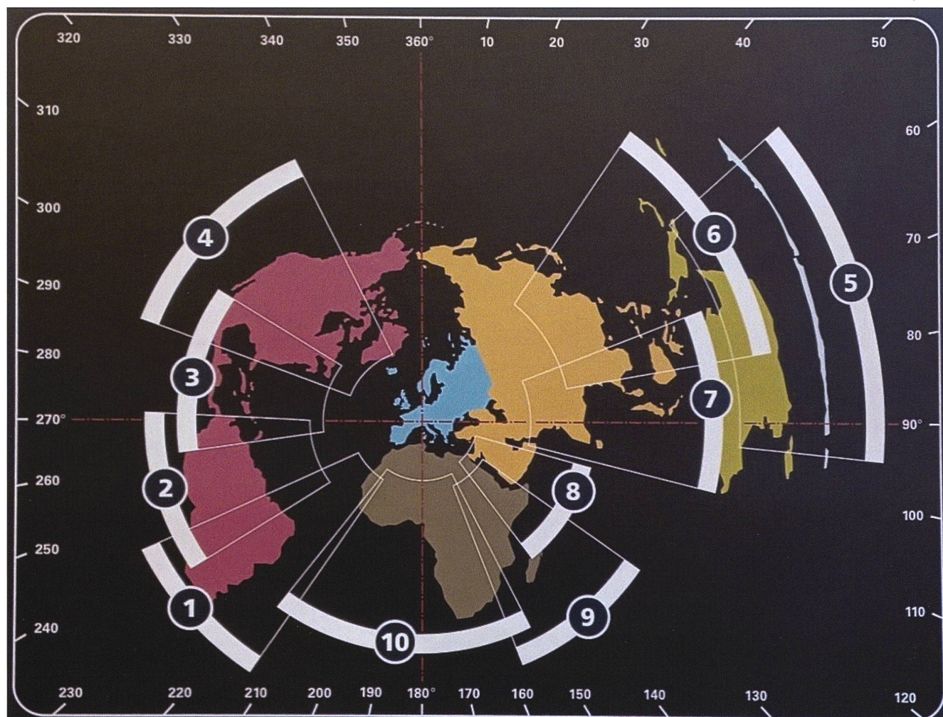
Esempio di settori di trasmissione OC sperimentati e collaudati sui quali si orienta l'antenna. In questo caso dalla stazione radio delle OC Svizzera (1932-2004). (MdR).
