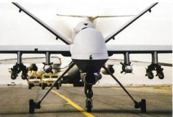
II MQ-1 Predator è un aeromobile a pilotaggio remoto (APR), dotato della possibilità di impiegare 2 missili AGM-114 Hellfire.
