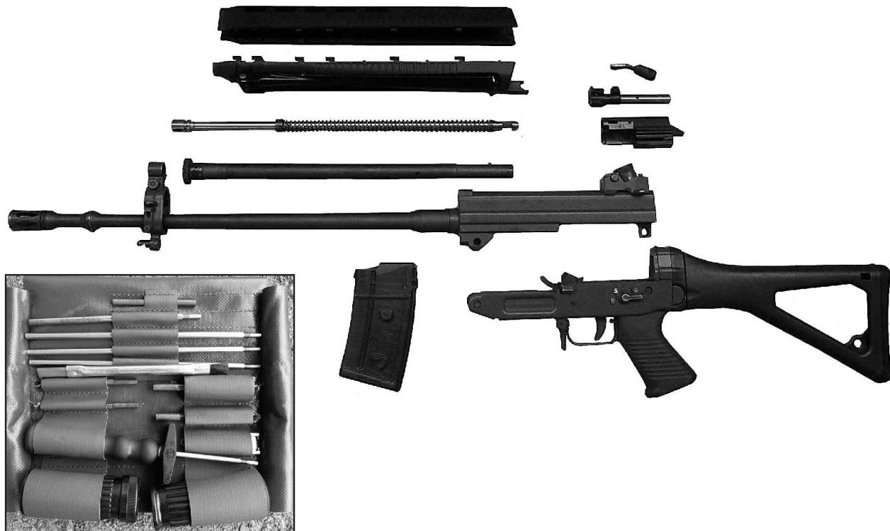
re/oliare leggermente il blocco presa gas, l'esterno della canna, l'interno della scatola della culatta in particolare le guide di scorrimento dell'otturatore, i contrafforti e la parte attorno alla camera delle cartucce. Ingrassare leggermente anche l'esterno.
