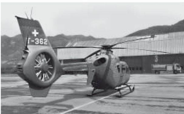
L'EC635 è spinto da due turbine Pratt & Whitney PW 206B2 che sviluppano 566 KW. Raggiunge una velocità di 256 km/h e vanta un'autonomia di 3 ore o 552 km. Può trasportare un massimo di 6 passeggeri.
