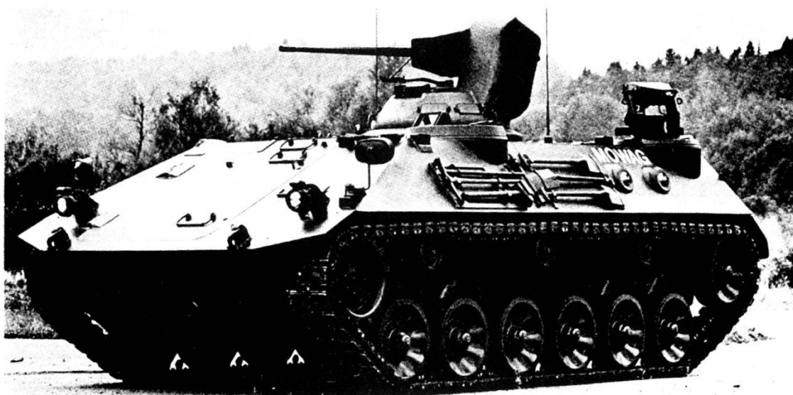
AMX 10 P (Francia) — Veicolo anfibia, relativamente leggero (13,8 t), senza feritoie; dispone di 1 can 20 mm e di 1 mitr su affusto esterno.
