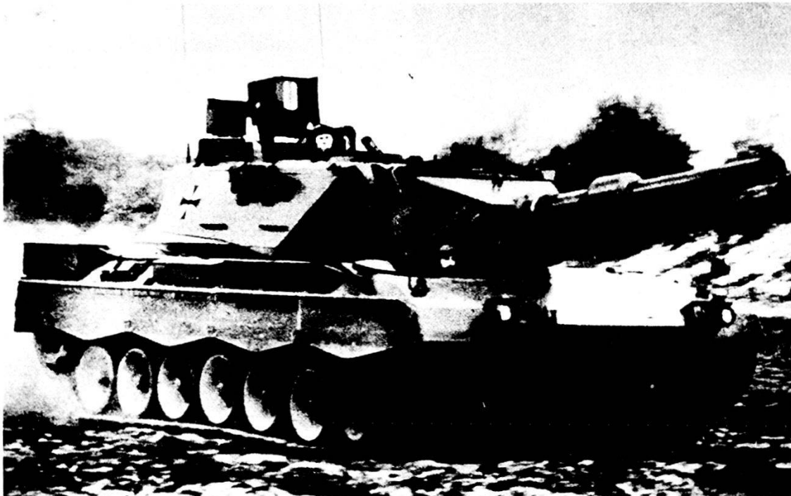
Leopard 2 — dati tecnici : peso: 50 t (pronto al cbt) - Armamento: 1 can 120 mm; 1 mitr 7,62 mm; 1 mitr DCA 7,62 mm - Motore/potenza: Diesel pluricarb 1500 PS; rapp potenza/peso: 29.75 PS/t; velocità max: 68 km/h; autonomia: 500 km - Equipaggio: 4 uomini.
