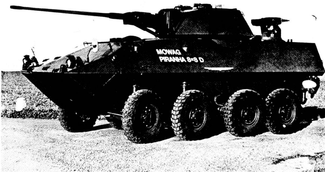
Piranha Mowag (Svizzera) — Veicolo a ruote (4×4, 6×6 oppure 8×8) di concezione moderna; anfibio. È adatto al montaggio di 1 can di 90 mm o di altre armi. Veicolo veloce sia sul terreno che in acqua (100 km/h, rispettivamente 10 km/h).
