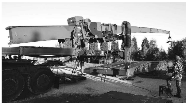
Unità di posa del ponte 45 m
