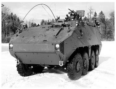
Il sistema d'esplorazione NBC integrati nel veicolo Piranha IIIC
