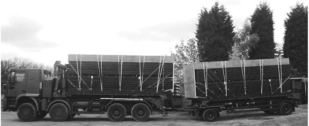
Materiale per "ponte di supporto 45 m" caricato su camion e rimorchio
