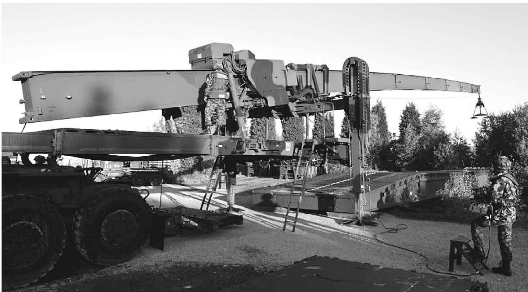
Unità di posa del ponte 45 m
