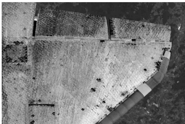
Danni alle navette spaziali Discovery e Endeavour da collisione con detriti orbitanti.
