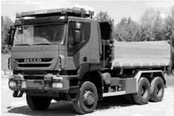
Esempio: autocarro IVECO 6x6 con ponte ribaltabile su tre lati
