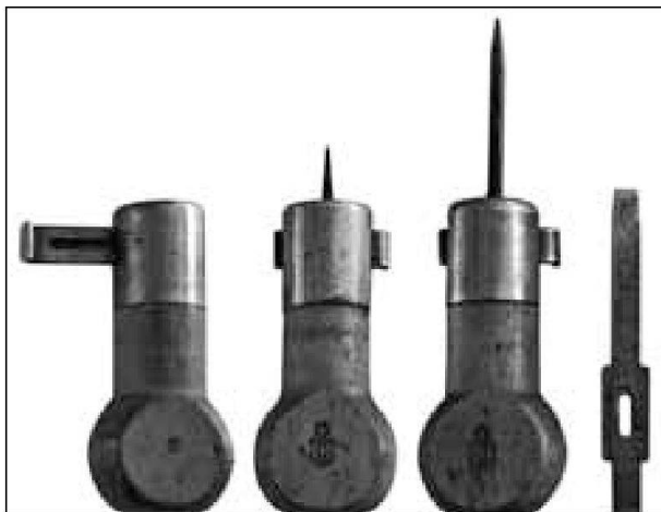
Il cacciavite per fucili Vetterli chiuso e aperto.
