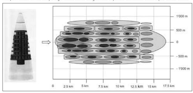
Esempio 2: testata chimica multipla al qas nervino Soman e diagramma di dispersione della nuvola tossica dopo 3 ore dall'attacco.
