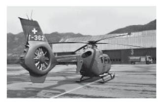
L'EC635 è spinto da due turbine Pratt & Whitney PW 206B2 che sviluppano 566 KW. Raggiunge una velocità di 256 km/h e vanta un'autonomia di 3 ore o 552 km. Può trasportare un massimo di 6 passeggeri.
