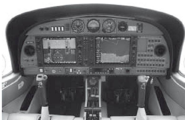
Immagine di un Glass Cockpit montato sull'aeroplano DA-42 Twin Star (Garmin-1000 displays)
