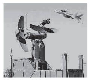
Radar di precisione per il volo d'avvicinamento
