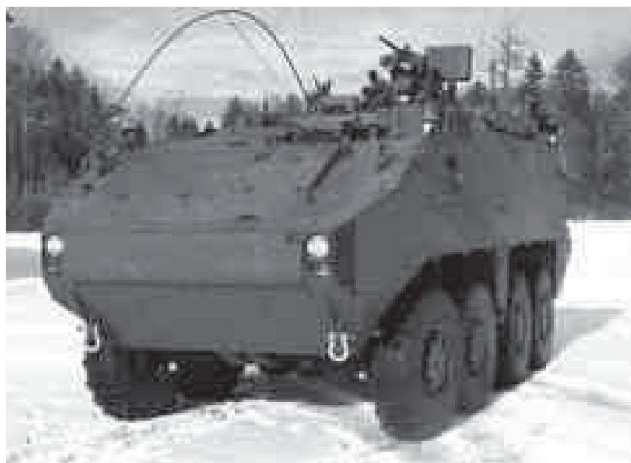
Veicolo d'esplorazione NBC (base PIRANHA IIIC, 8x8)
