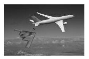
kg di carburante il minuto ciascuno (vedi secondo fotomontaggio con due F/A-18). Il KC-45 sarà un aereo ad alta tecnologia: sarà dotato ad esempio di un sistema di pilotaggio computerizzato ("fly-by-wire"), della gestione del rifornimento con controlli remoti, di un'avionica con schermi moderni 2D e 3D a colori, di suite per la guerra elettronica contro le minacce della contraerea, di sistemi di comunicazione digitali basati sul sistema "Link 16" ecc.
