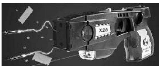
Taser X26 batteria di 7.2 volt alimenta i circuiti elettrici.
