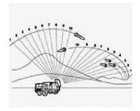
b) Fuoco amico: COBRA è pure in grado di determinare gli errori di tiro dei propri cannoni d'artiglieria e di calcolarne le correzioni.
