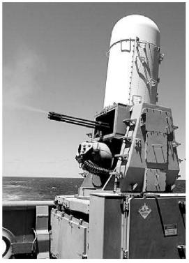
Oerlikon-Contraves (ora Rheinmetall) con la munizione Ahead da 35 mm (vedi anche RMSI No 6 / 2005), e il sistema "Phalanx" della statunitense Raytheon, un cannone Gatling con munizione calibro 20 mm (foto).
