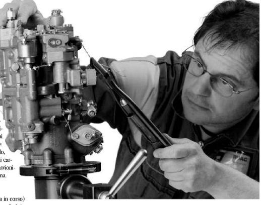
anzitutto eseguire minuziosi test in officina. Su banchi di prova per motori si simulano le condizioni limite d'impiego, si misura la potenza erogata, il momento di coppia, il numero di giri, la consumazione di carburante ecc. Se necessario si eseguono le regolazioni del caso, ad esempio sugli iniettori di carburante. Dopo ogni prova finale viene rilasciato un corrispondente certificato di aero-navigabilità.
