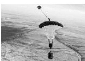
il calcolo della traiettoria e delle correzioni in volo. Come per lo "Snow Goose" anche per "Onyx" è necessario memorizzare nel computer le coordinate del punto d'atterraggio previsto prima della missione. "Onyx" è lanciato da un aereo da trasporto anche da quote elevate, fino ad un massimo di 10'700 metri sul livello del mare. Può trasportare un carico utile da un minimo di 34 kg ad un massimo di 1'000 kg.
