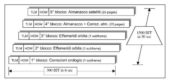
Fig. 10: Struttura del Messaggio di Navigazione
