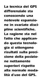
Le tecniche del GPS differenziale permettono di annullare completamente gli errori di misura dovuti al satellite (effemeridi e orologi) e di ridurre sensibilmente gli errori dovuti alla propagazione nell'atmosfera (troposfera e ionosfera). Con un **DGPS** si ottengono in generale precisioni sulla posizione inferiori ai 6 metri, sovente tra 2 e 3 metri.
