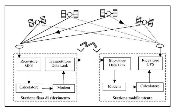
Fig. 11: Principio di funzionamento del DGPS
