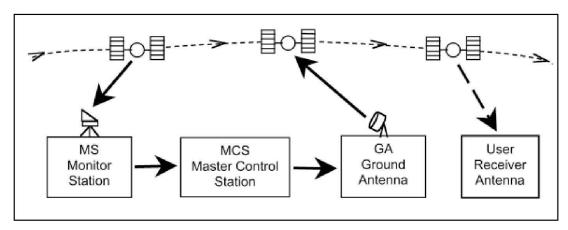
Fig. 8: procedura per la determinazione della posizione del satellite
