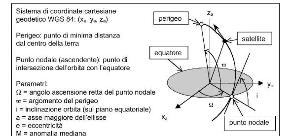
Fig. 9: Definizioni delle effemeridi dell'orbita
