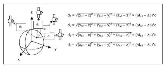
Fig. 6: Le 4 equazioni di base per un sistema di navigazione satellitare
