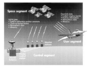
Fig. 3: rappresentazione schematica dei tre "segmenti" (da: Aerospace Corporation, 1996)
