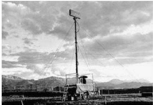
Ricorderemo che i radar PSTAR per la ricerca e l'inseguimento di aerei e di elicotteri saranno integrati nelle unità di difesa contraerea dotati dei missili Stinger. Ogni radar PSTAR sarà collegato con diverse batterie Stinger che saranno messe selettivamente in stato di allerta e potranno ottenere informazioni sul volo dell'aeromobile da intercettare a distanze anche superiori alle possibilità di avvistamento visive.
