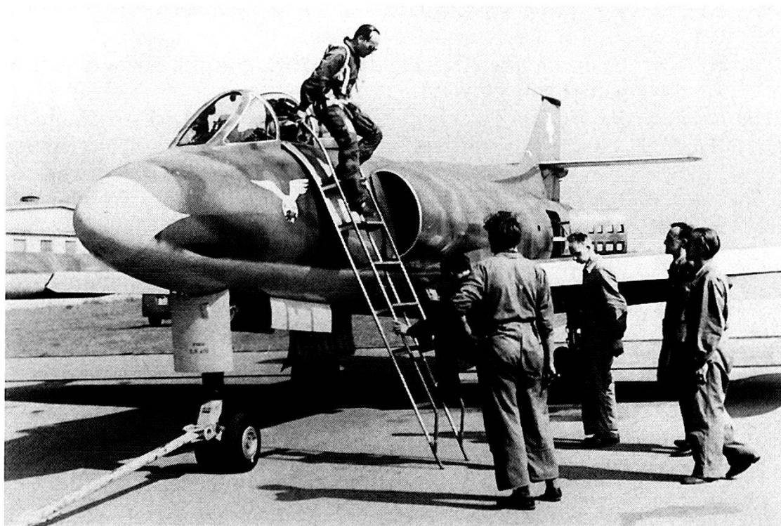
Altenrhein 1959: il pilota collaudatore delle FFA Hans Bardill scende dal P-16 HB-VAC. Nella parte posteriore sono chiaramente riconoscibili gli aerofreni aperti.
