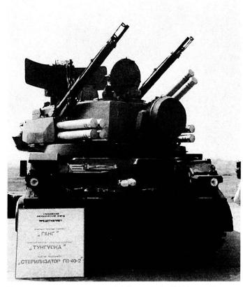
Il semovente controaerei binato/missilistico «Tunguska», concepito per sostituire lo ZSU-23-4, è armato con 2 cannoni da 30 mm ed 8 missili SA-19.
