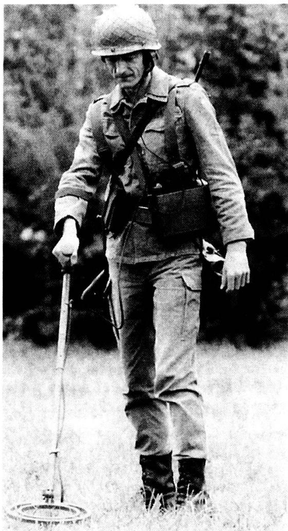
**Il cercamino AN-19/2 di «Schiebel» fu sperimentato con successo sia dalla Bundeswehr che da altri membri della NATO, in quanto permette il reperimento di mine contenenti una minima quantità di componenti metallici.**
