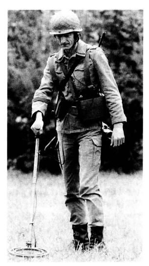
Il cercamine AN-19/2 di «Schiebel» fu sperimentato con successo sia dalla Bundeswehr che da altri membri della NATO, in quanto permette il reperimento di mine contenenti una minima quantità di componenti metallici.
