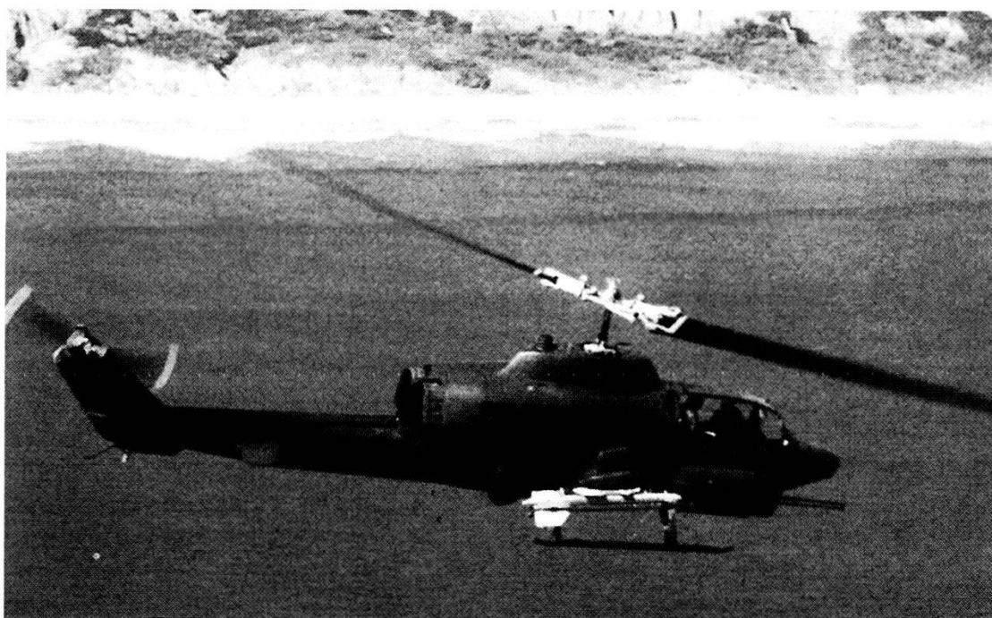
Elicottero statunitense d'attacco Bell AH-1W «Super Cobra» equipaggiato con missili aria-aria «Sidewinder».
