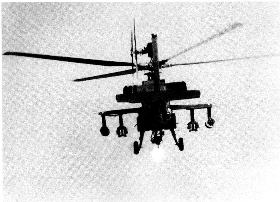
Elicottero statunitense AH-64 «Apache» mentre impiega il cannone automatico M-230 da 30 mm.
