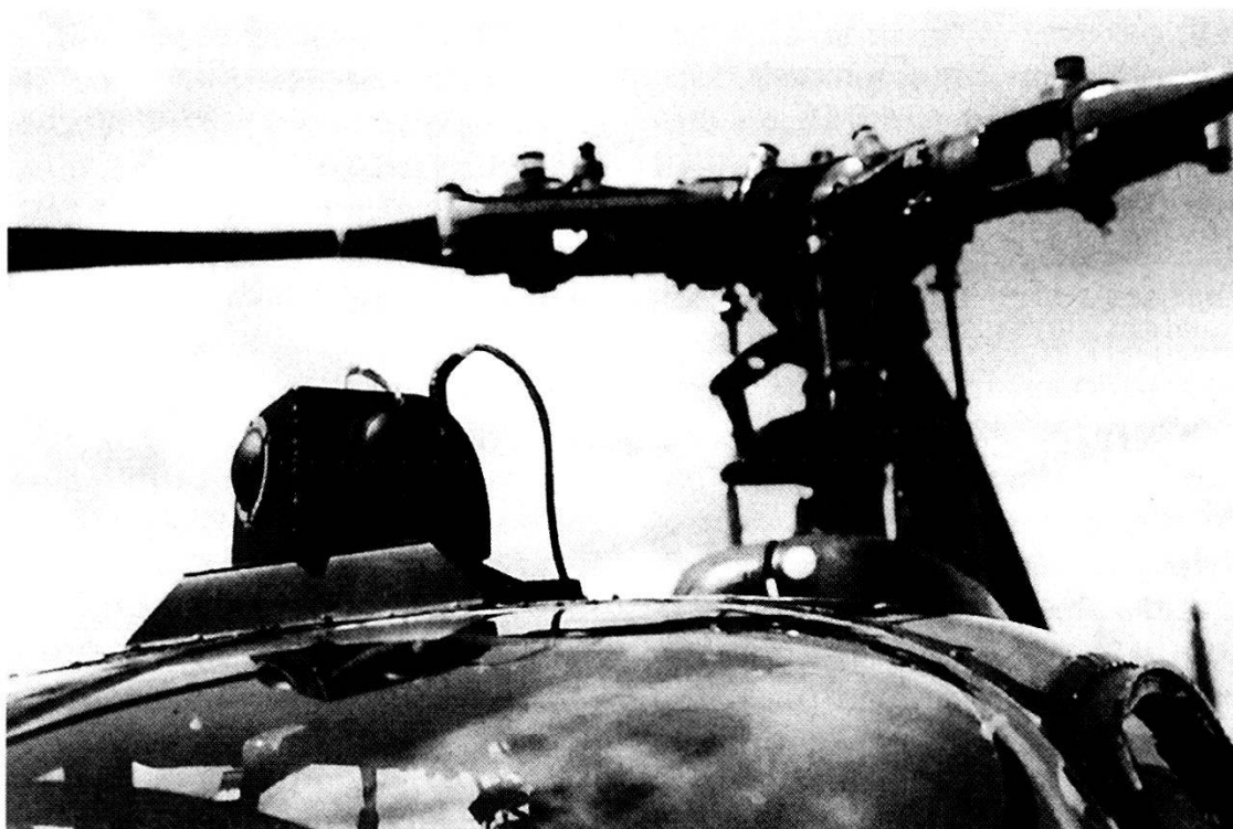
Particolare del ricevitore di allarme radar (RWR) montato sul cielo della cabina di un elicottero «Gazelle».
