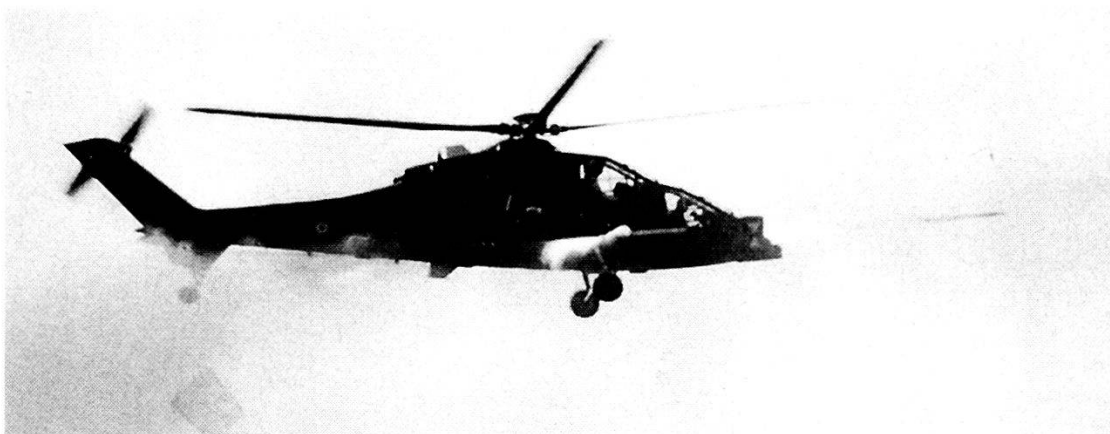
Lancio di razzi da 81 mm del sistema «Medusa» da un elicottero italiano d'attacco A-129 «Mangusta».
