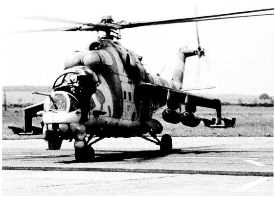
L'elicottero Mil Mi-24 è in grado di trasportare oltre ai 3 uomini di equipaggio 10 soldati in assetto da combattimento o un carico di 2850 kg.
