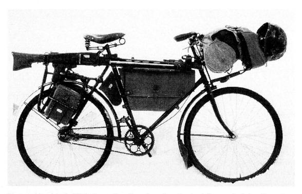
La macchina (mod. 1905) di un mitragliere. La mitragliatrice è fissata al telaio e il pacchettaggio al manubrio. Ai due lati della ruota posteriore sono sistemati due cofanetti di munizioni.
