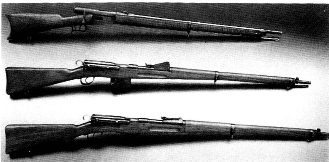
**Il fucile a ripetizione Vetterli, mod. 1869, ha una lunghezza di 1300 mm, calibro 10,4 mm, peso 4670 g, canna rigata in acciaio fuso, brunito. Otturatore a cilindro scorrevole. Il magazzino, situato sotto la canna, ospita 12 cartucce con pallottola di piombo di 20,13 g e 4 g di polvere nera. Velocità iniziale: 435 m/s. Portata massima: 750 m. Cadenza di fuoco: 21 c/min.**
