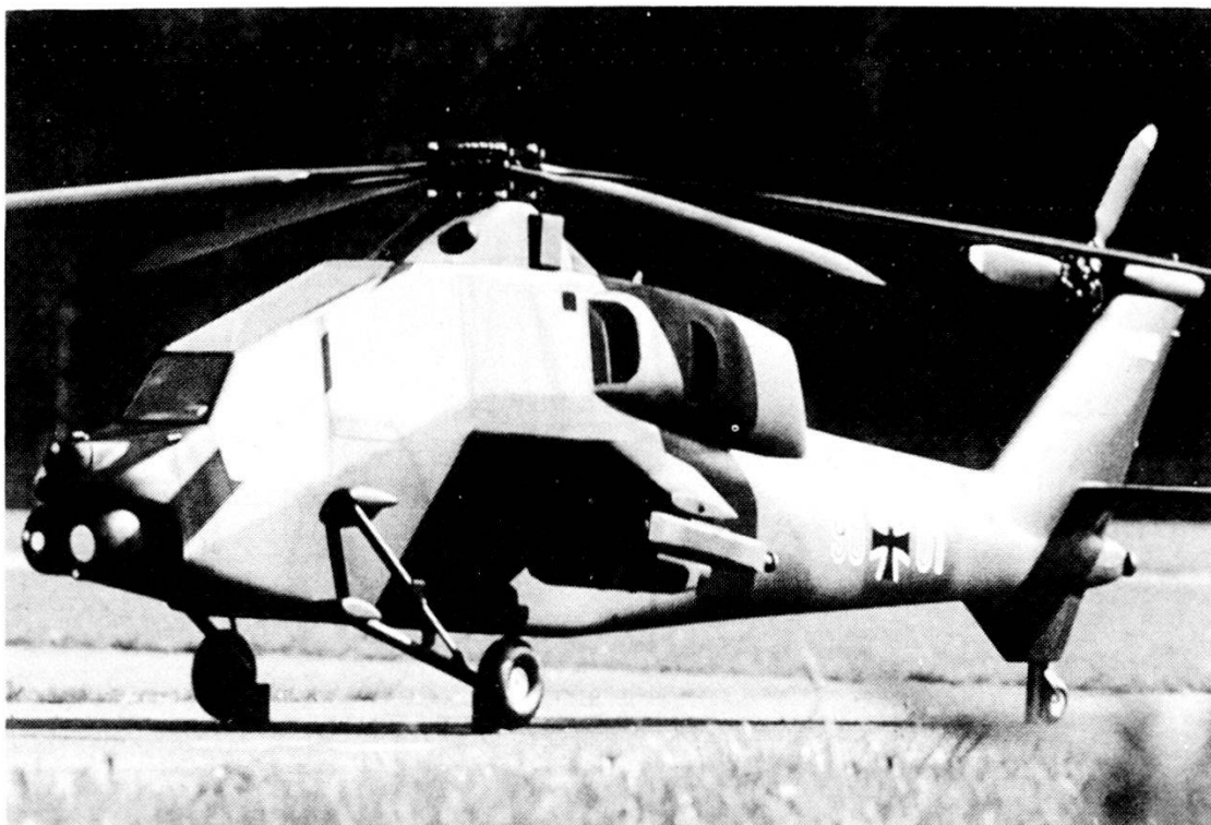
Il simulacro del futuro elicottero controcarri della Heeresflieger. È evidente l'ispirazione al Mangusta italiano. L'armamento e gli apparati di visionica montati gli consentiranno il combattimento notturno e in condizioni marginali di visibilità.
