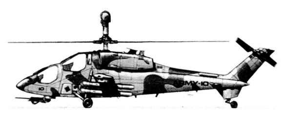
La derivazione della versione da esplorazione della versione base dell'A-129. L'armamento previsto sarà costituito da mitragliatrice di medio calibro 12.7 o 20 mm e missili aria-aria (USA).
