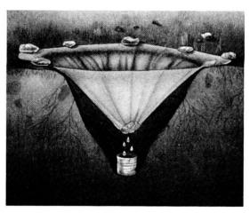
Il disegno mostra come l'aria imprigionata sotto il telo offra gocce di vapore condensato che si raccolgono nel recipiente sottostante.
