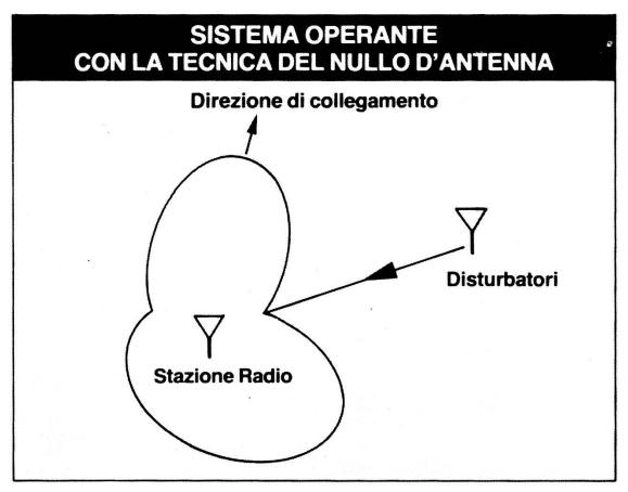
Diagramma di irradiazioni di un sistema operante con la tecnica del «nullo d'antenna». Le dimensioni del diagaramma, proporzionali al segnale ricevuto, evidenziano l'effetto riduttivo nei confronti del segnale distrubatore.
