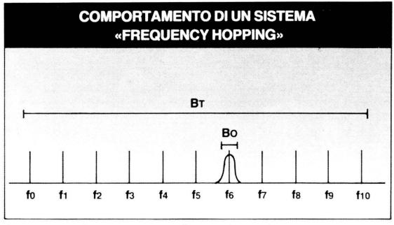
Comportamento di un ipotetico sistema frequency hopping in grado di saltare su 11 frequenze, indicate con i simboli  $F_0 ext{...} ext{ } F_{10}$  nell'unità di tempo. Bo è la larghezza del segnale, Bt la larghezza di band complessivamente impeganta nell'unità di tempo.
