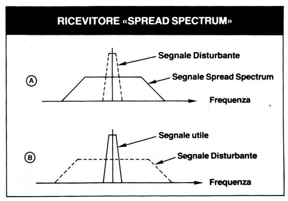
Comportamento di un ricevitore spread spectrum in presenza di un segnale disturbatore a banda stretta. Disegno A: all'ingresso del ricevitore il segnale distrurbante ha un livello superiore allo spread spectrum. Disegno B: comprensione del segnale spread spectrum e dispersione del disturbo nel ricevitore.
