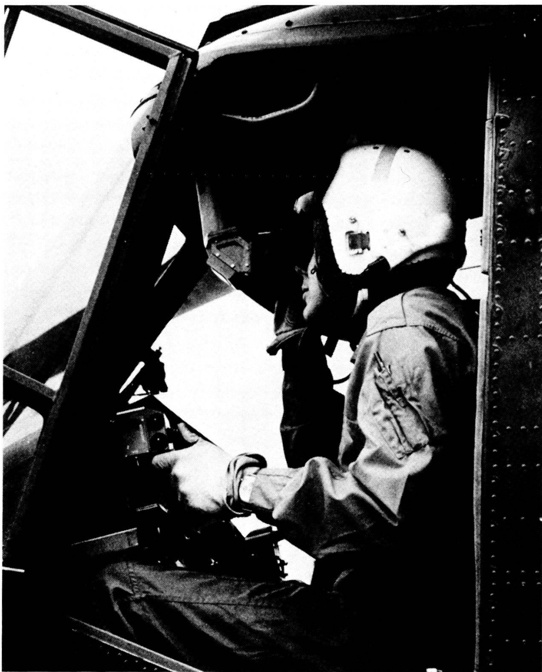
Apparecchio di mira APX M 397 per ordigno teleguidato anticarro Milan (Lynx).
