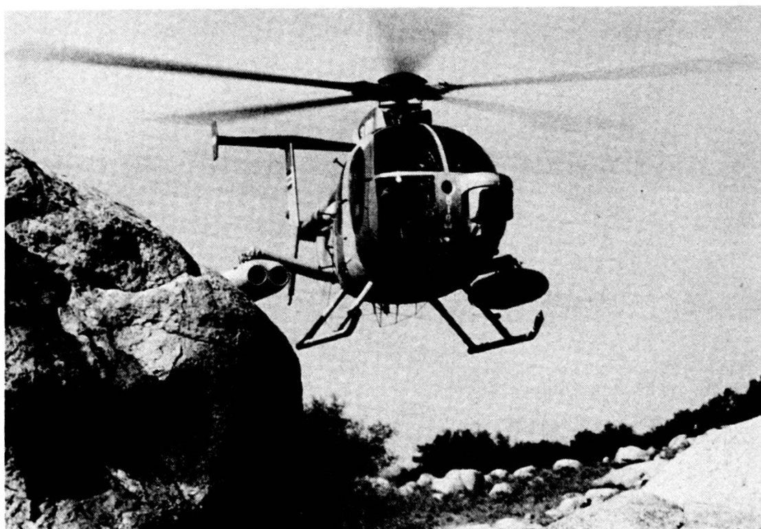
Elicottero Hughes 500 MD Defender con ordigni teleguidati TOW. Davanti a destra l'apparecchio di mira elettro-ottico.
