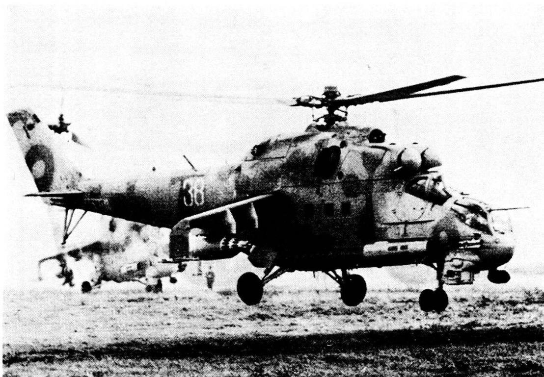
Mi-24 HIND/E con supporto doppio per AT-6 Spiral, contenitore razzi UB-32 e, nuovo, nella parte anteriore della fusoliera una cabina con un cannone doppio automatico di 23 mm.
