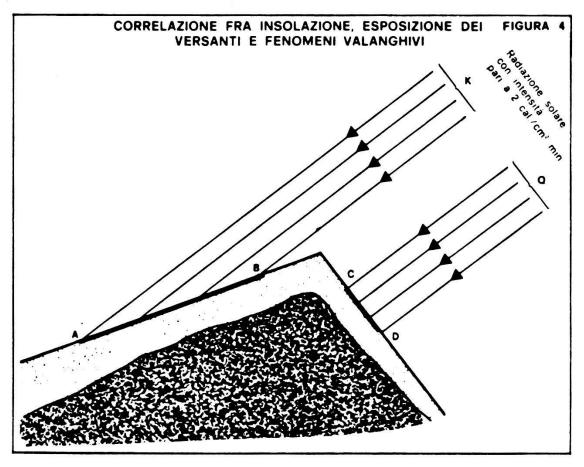
I fasci di radiazione K e Q, di eguale intensità e banda, colpendo la superficie terrestre con diversi angoli d'impatto, interessano superfici di diversa dimensione.
