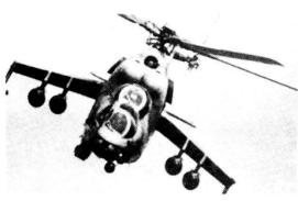
Fig. 8. Elicottero da combattimento Mi-24 «Hind» con armi anticarro teleguidate.
