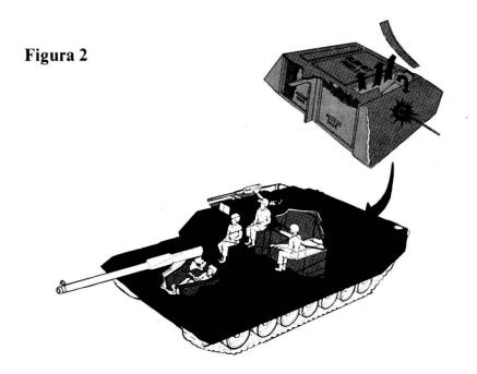
la sua parte superiore con delle placche metalliche fissate in modo tale che qualora questo compartimento venga colpito da un proiettile, l'esplosione della munizione distacca queste placche scaricando all'esterno la pressione creatasi.
