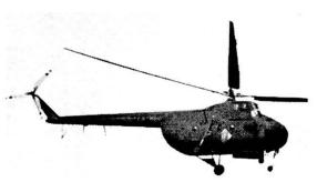
Fig. 1. Elicottero medio Mi-4 «Hound» con portellone di carico a due battenti posteriore e coppa d'atterraggio, con o senza armamento sotto la parte anteriore della carlinga.
