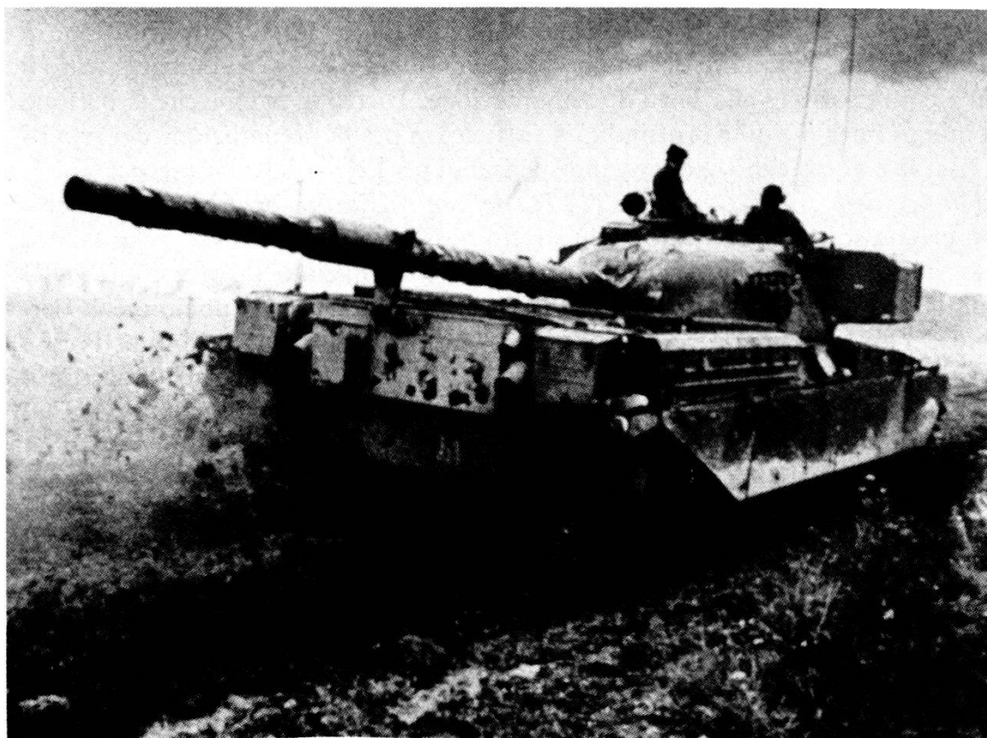
Fig. 1. Le truppe britanniche hanno in dotazione il carro da combattimento «Chieftain». Esso dispone di un cannone stabilizzato di 120 mm, con canna rigata e di un telemetro-Laser. Peso 54 t. Equipaggio: 4 uomini.
